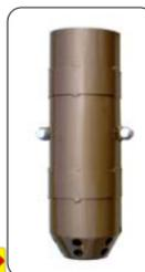
\*ノイズサイレンサーを取付けてハツリ作業を行う際に使用するエンジンコンプレッサは、必ずアフタークーラー付きの機種をご使用ください。アフタークーラー付き以外のエンジンコンプレッサを使用してハツリ作業を行うと、圧縮空気中に含まれる水分によって、圧縮空気通過部分吸音フォームに水分が吸着され、騒音の吸音効果が損なわれます。また、冬季においては、吸音フォームに吸着された水分が凍結することにより、吸音フォームの破損並びにハンドブレイカ自体の故障を発生させます。
